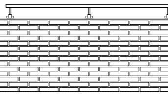
**Barandilla sobre parapeto** | Guarda-corpos sobre parapeito | Rampe sur parapet | Railing over parapet
