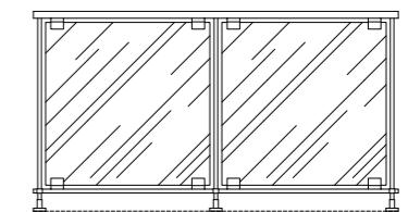
**Barandilla de vidrio total con soporte portavidrio** | Guarda-corpo de vidro integral com suporte de vidro | Remplissage verre sous main courante avec pinces | Total glass railing with brackets
