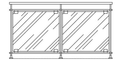
**Barandilla de vidrio total con soporte portavidrio y borde superior libre** | Guarda-corpo de vidro integral com suporte de vidro e borda superior livre | Bande filante sous lisse avec remplissage verre avec pinces | Total glass railing with brackets and separated upper handrail
