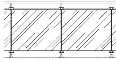
**Barandilla de vidrio con borde superior libre** | Guarda-corpo de vidro com borda superior livre | Bande filante sous lisse avec remplissage verre | Total glass railing with separated upper handrail
